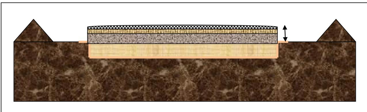
Вариант исправленной ситуации: исправленные профили трассы за счёт существующего грунта. Это позволило расширить трассу до 4-х метров, но на отдельных участках возможно расширение и до 5-7 м для полноценных обгонов.
